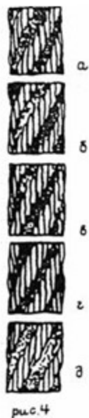
Рис. 4. Износ наружных проволок каната крестовой свивки: a - небольшие лыски на проволоках; б - увеличенная длина лысок на отдельных проволоках; в - удлинение лысок в отдельных проволоках при заметном уменьшении диаметра проволок; г - лыски на всех проволоках, уменьшение диаметра каната; д - интенсивный износ всех наружных проволок каната (уменьшение диаметра проволок на 40%)
